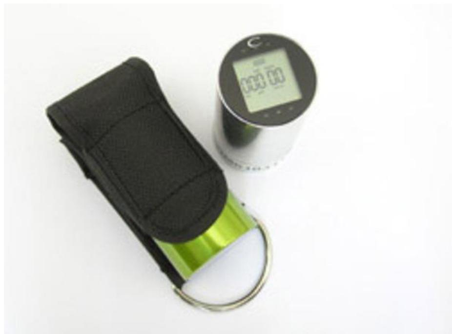
Figure A-9. CairClip O<sub>3</sub>/NO<sub>2</sub> sensor.
