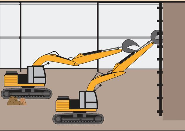
La deconstrucción se realiza bajo presión de aire negativa para evitar que el polvo se mueva fuera del sitio. Los trabajadores deconstruirán el edificio utilizando excavadoras para cortar metal y derribar cada pieza del edificio.
