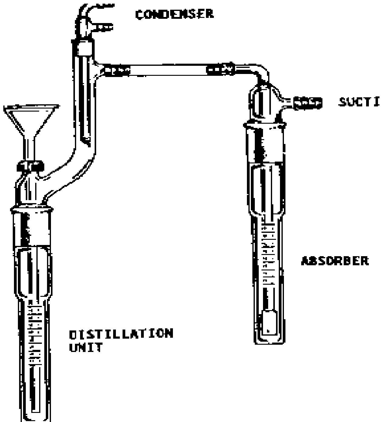
**FIGURE 1. MIDI DISTILLATION APPARATUS**
