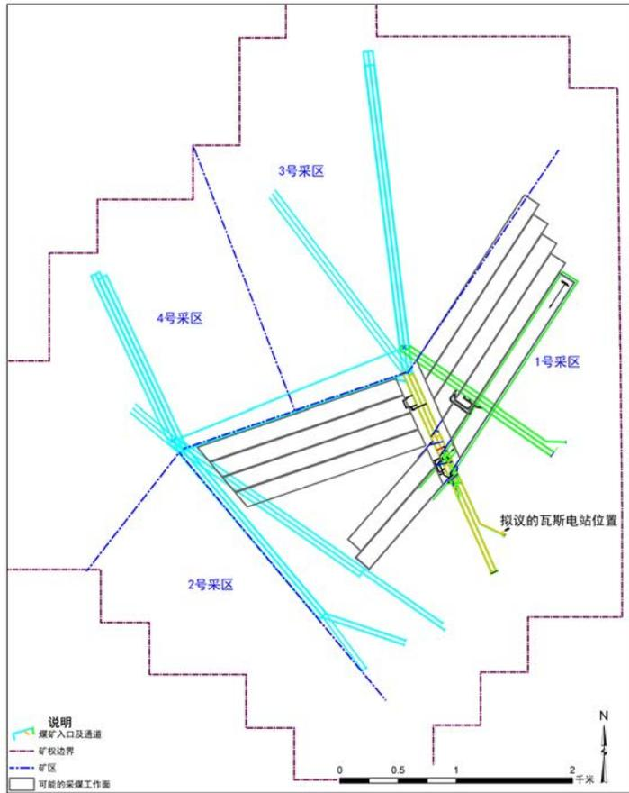
图示 11: 拟议的预抽钻井布置
