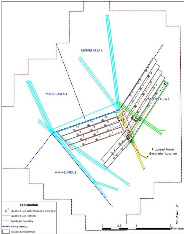
图示 14: 拟议的采空区钻井布置
