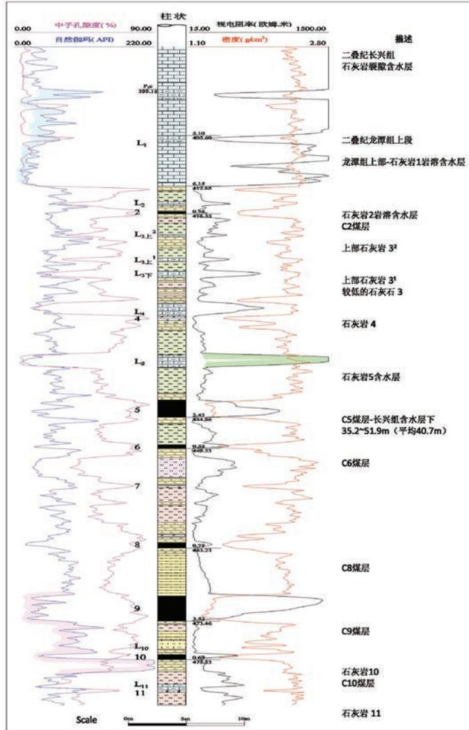
图示 3: 含煤及含水层地层剖面图
