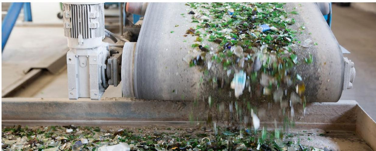
Maquinaria que rompe y combina vidrios en una instalación de reciclaje. Este vidrio roto, denominado polvo de vidrio, se puede mezclar con arena, piedra caliza y otras materias primas para producir vidrio fundido, que se usa para fabricar botellas y frascos nuevos.
