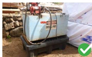
Tanque de combustible diesel almacenado en paleta de contención secundaria
