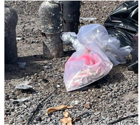
Pink na pintura = Pinaghihinalaang asbestos na naglalalaman ng materyal.
