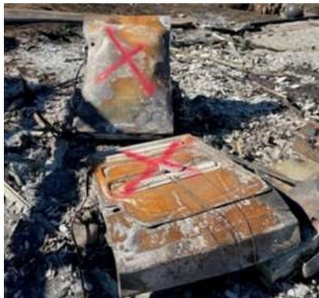
赤色ペンキ：リチウム電池のパワーウォール、または太陽光発電装置が残されている状態の印。
