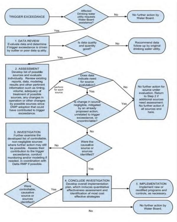
FIGURE 4-1: SCHEMATIC OVERVIEW OF ACTIONS PROMPTED BY CRYPTOSPORIDIUM TRIGGER EXCEEDANCE
