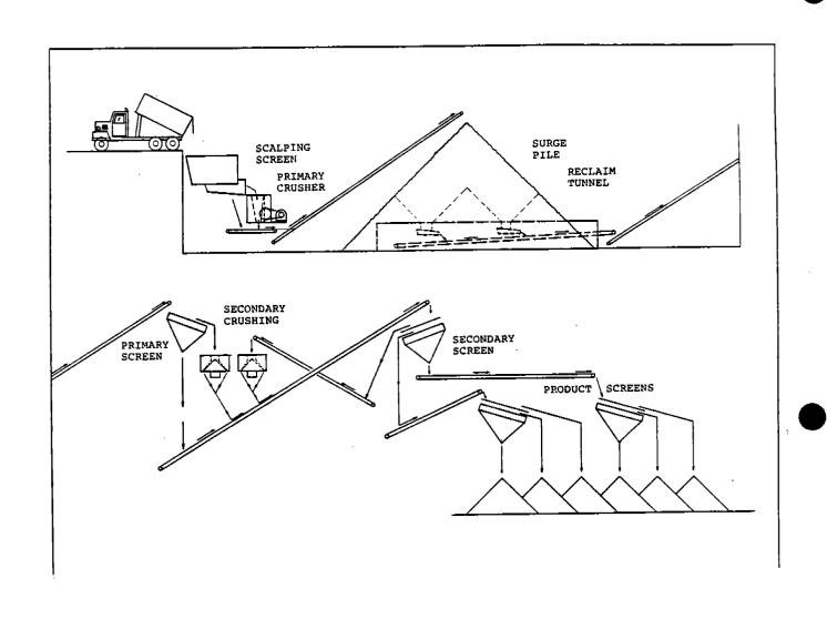
FIGURE 8.19.2-1. TYPICAL STONE PROCESSING PLANT
