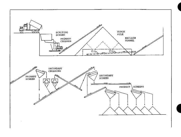
FIGURE 8.19.2-1. TYPICAL STONE PROCESSING PLANT
