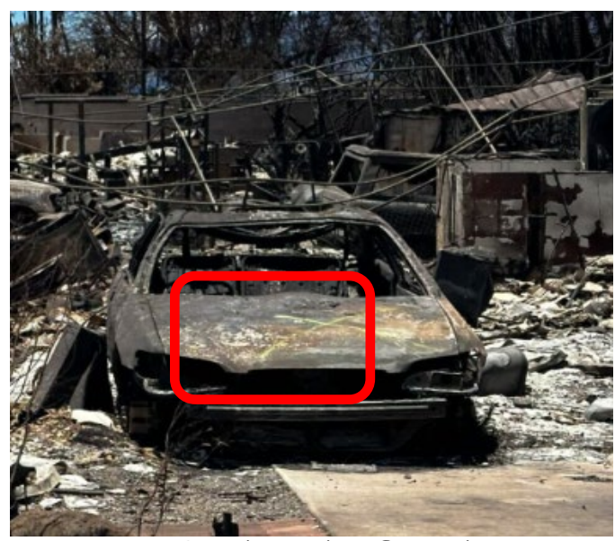
Սպիտակ «O» նշան մեքենայի կապուտի վրա = Ոչ էլեկտրական մեքենա (EV) մարտկոցով Սպիտակ «X» մեքենայի կապուտի վրա = Ոչ էլեկտրական մեքենայի մարտկոցը հեռացվել է
