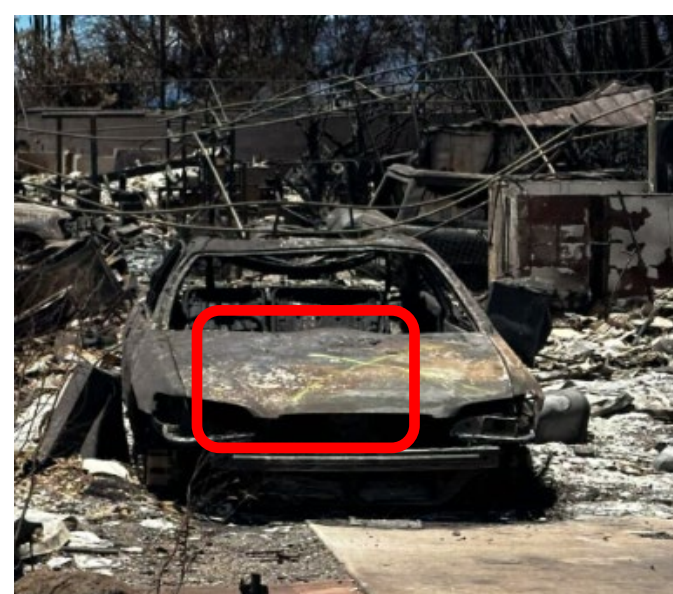
车辆引擎盖上的白色“O”标记 = 带电池 的非电动汽车 (EV) 车辆引擎盖上的白色“X” = 已拆除非电动 汽车电池
