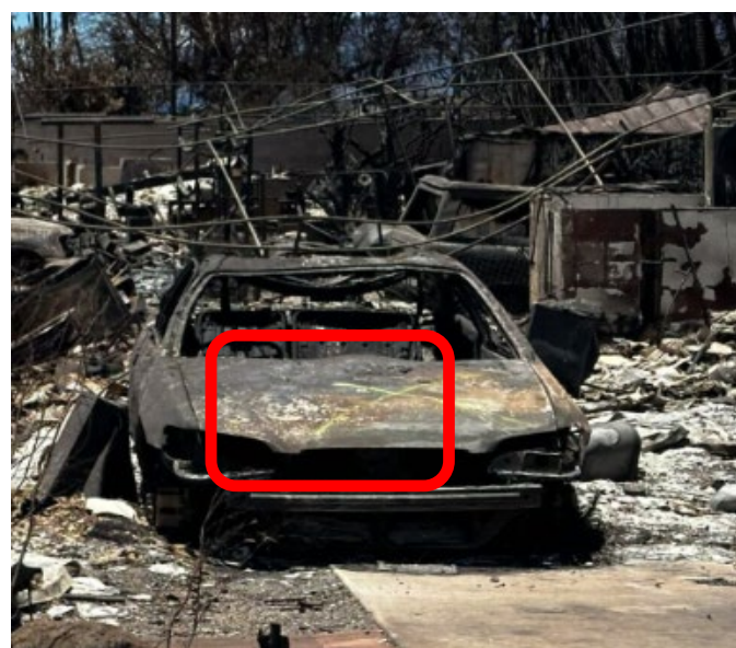
車輛引擎蓋上的白色“O”標記 = 帶電池的 非電動汽車 (EV) 車輛引擎蓋上的白色“X” = 已拆除非電動 汽車電池
