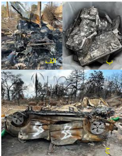
الف. یک بیل مکانیکی بسته باتری یک وسیله نقلیه الکتریکی را باز می کند ب. برای حمل و نقل ایمن به مناطق استقرار، کارمندان باتری‌ها را در بشکه‌های پوشش دار ج. کارمندان خودروهای الکتریکی را پس از برداشتن باتری‌ها با علامت رعد و برق سفید علامت گذاری می کنند
