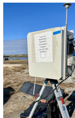
Las estaciones de monitoreo diario de la calidad del aire tanto en las instalaciones como en la comunidad circundante, recolectan datos sobre la calidad del aire las 24 horas al día los 7 días a la semana
